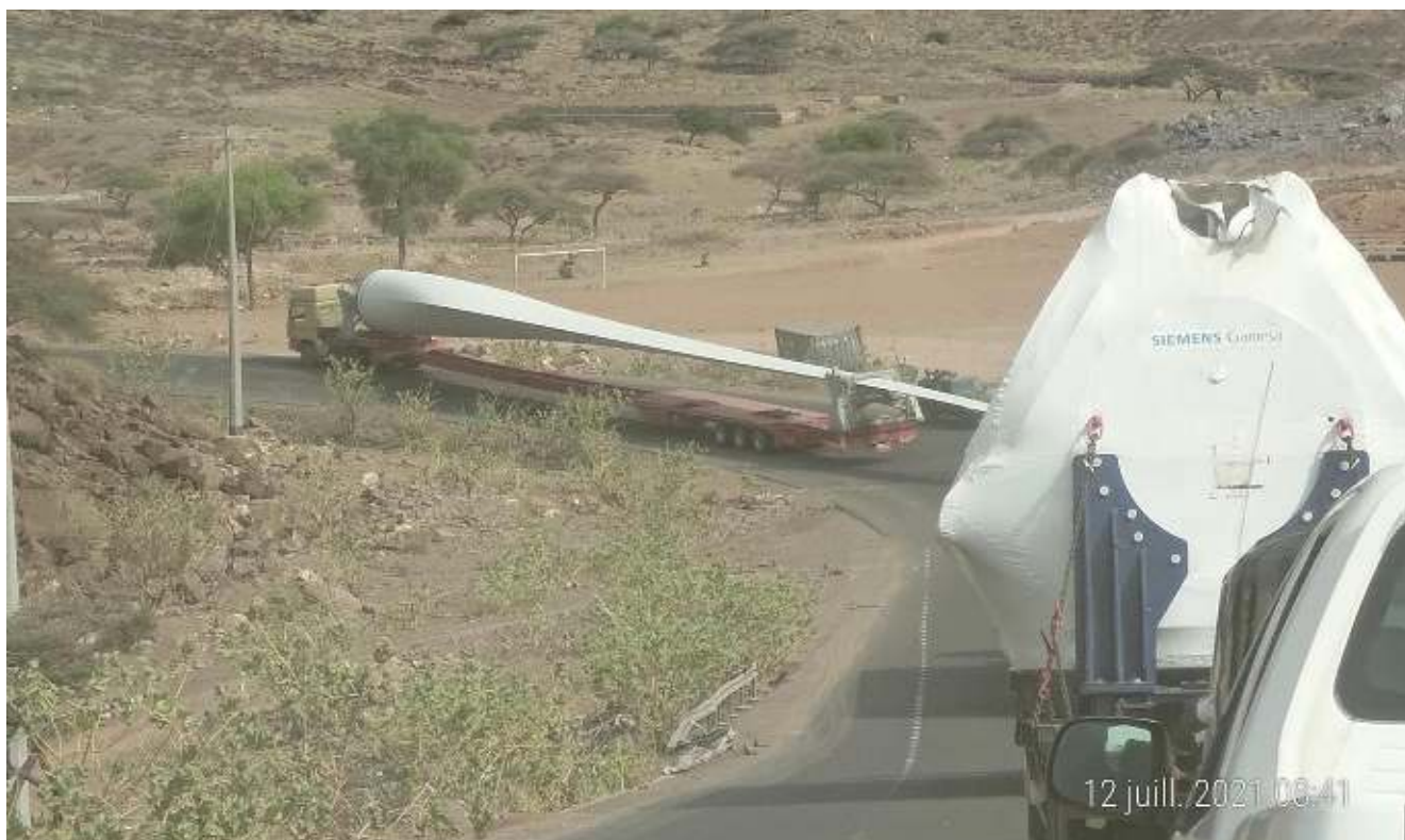
Figure 21: Transport des éoliennes sur la RN1 vers le site d'implantation, juillet 2021
