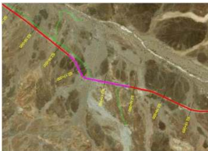
Figure 3 : section de route de la RN19 ayant un rayon de courbure non conforme à l'ARP (source
