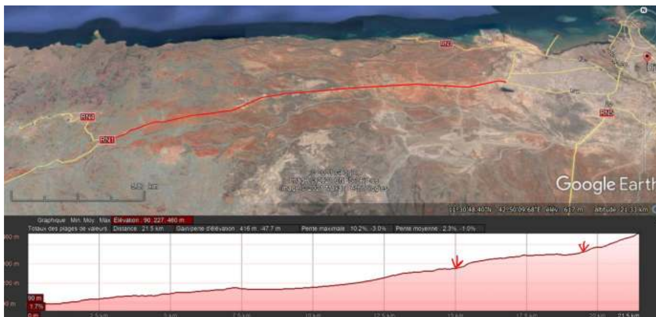
Figure 9 : Profil de dénivelée du PK 13 au PK34
